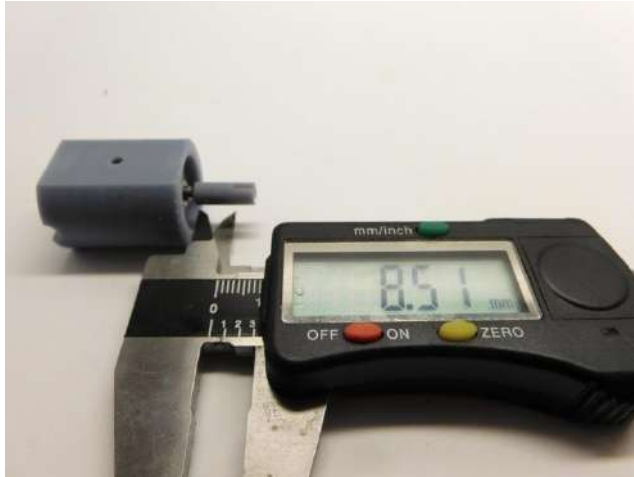
Maße prüfen Check dimensions Controleer de maatvoering
