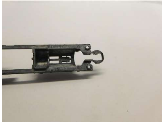
Schaffen Sie Platz für das Schnecke Make extra room for the worm gear Maak ruimte voor het wormwiel
