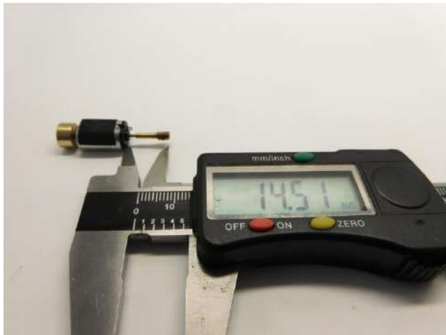
Maße prüfen Check dimensions Controleer de maatvoering
