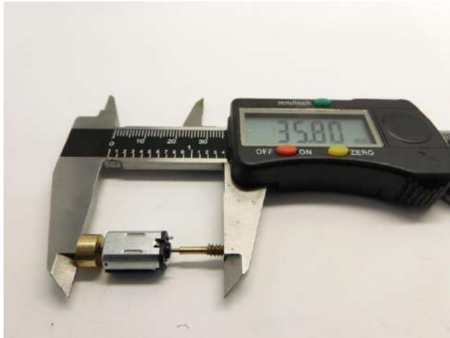
Maße prüfen Check dimensions Controleer de maatvoering
