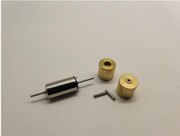
Die Metallteile werden mit Loctite oder Metall Epoxy kleber verklebt The metal parts are glued with loctite or metal epoxy glue Metalen onderdelen worden gelijmd met metaallijm of epoxylijm voor metalen
