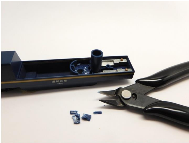
Platz für den Motor schaffen Make room for the motor Maak ruimte voor de motor
