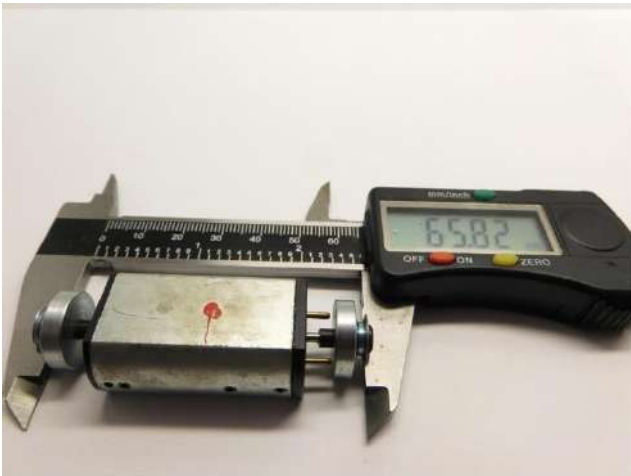
Maße prüfen Check dimensions Controleer de maatvoering
