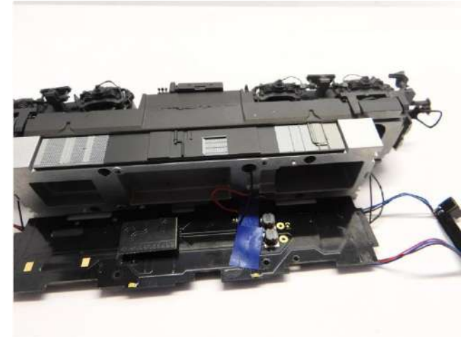
Kontakten isolieren Isolate the contacts Isoldeer de contacten
