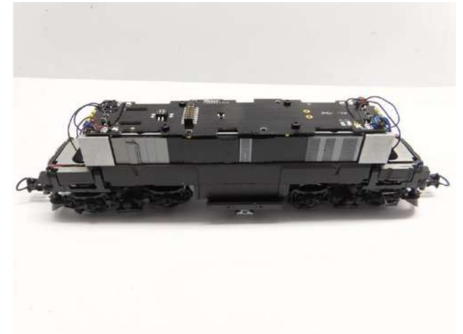
Platine platzieren Place the PCB Plaats de printplaat
