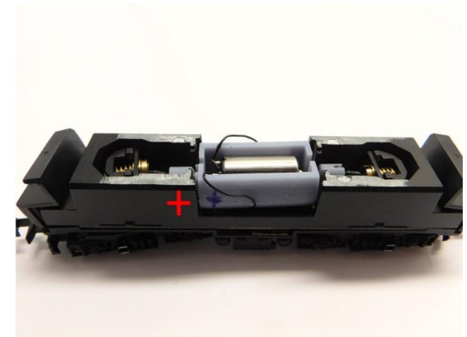
Motor im Motorhalter platzieren Place motor in motor holder Plaats de motor in de motor houder
