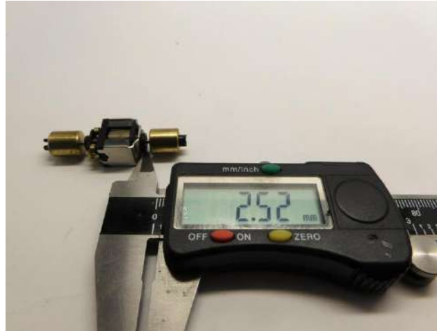
Maße prüfen Check dimensions Controleer de maatvoering
