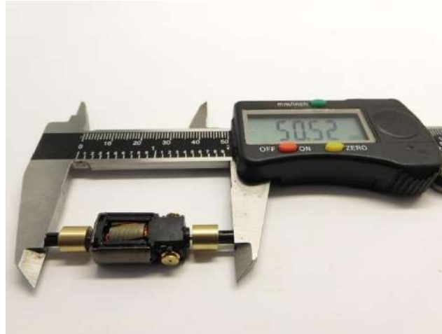
Maße prüfen Check dimensions Controleer de maatvoering
