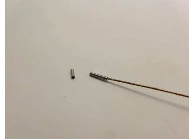
Tragen Sie Klebstoff auf die Innenseite von den Teilen Apply glue on the inside of the parts Plaats alleen lijm aan de binnenzijde van de onderdelen
