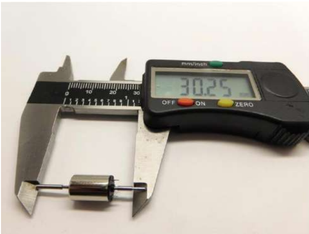
Maße prüfen Check dimensions Controleer de maatvoering
