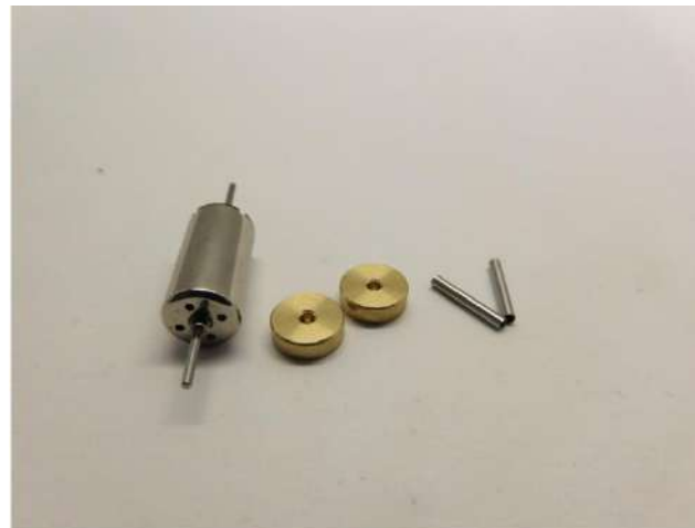
Metallteile werden mit Loctite oder Metal Kleber verklebt Metal parts are glued with Loctite or metal glue Metalen onderdelen worden gelijmd met metaallijm of epoxylijm voor metalen
