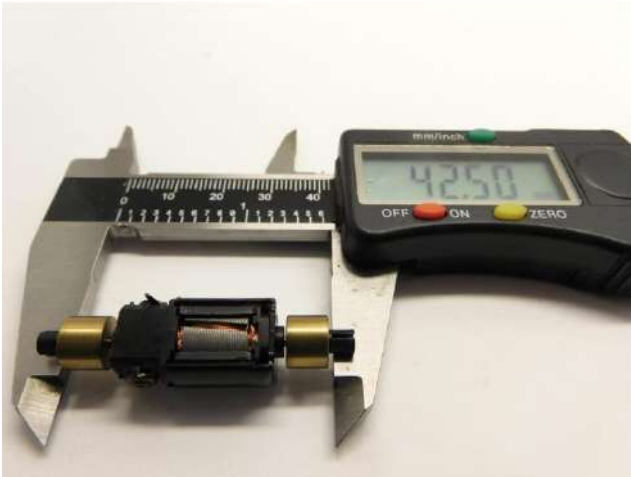
Maße prüfen Check dimensions Controleer de maatvoering
