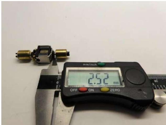
Maße prüfen Check dimensions Controleer de maatvoering
