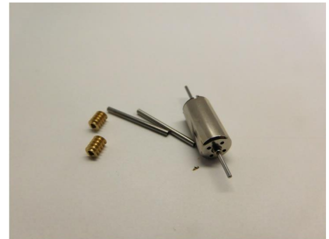
Metal Teile werden mit Metallkleber verklebt Metal parts are glued with metal glue
