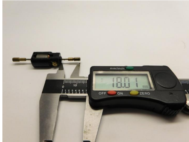
Maße prüfen Check dimensions Controleer de maatvoering
