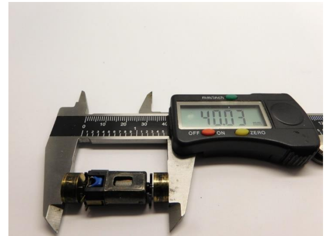
Maße prüfen Check dimensions Controleer de maatvoering
