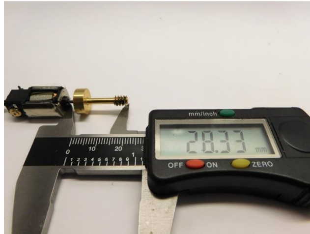
Maße prüfen Check dimensions Controleer de maatvoering
