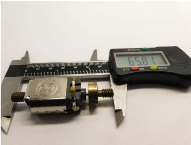
Maße prüfen Check dimensions Controleer de maatvoering
