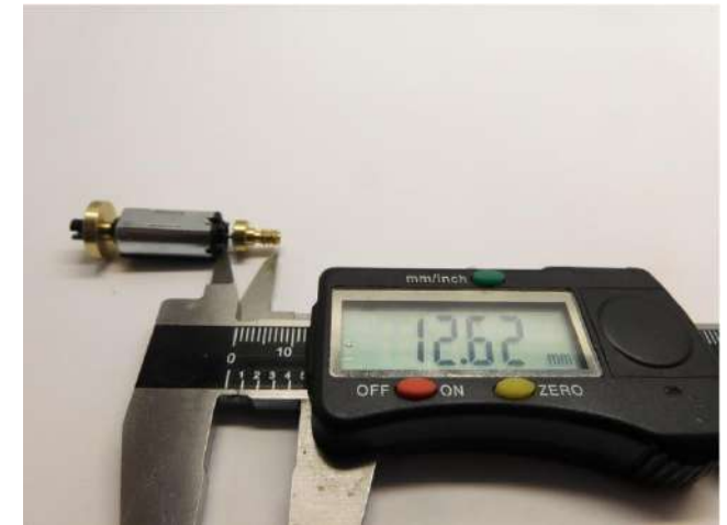
Maße prüfen Check dimensions Controleer de maatvoering
