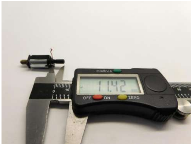
Maße prüfen Check dimensions Controleer de maatvoering
