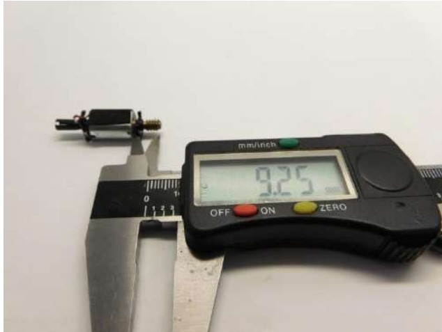
Maße prüfen Check dimensions Controleer de maatvoering
