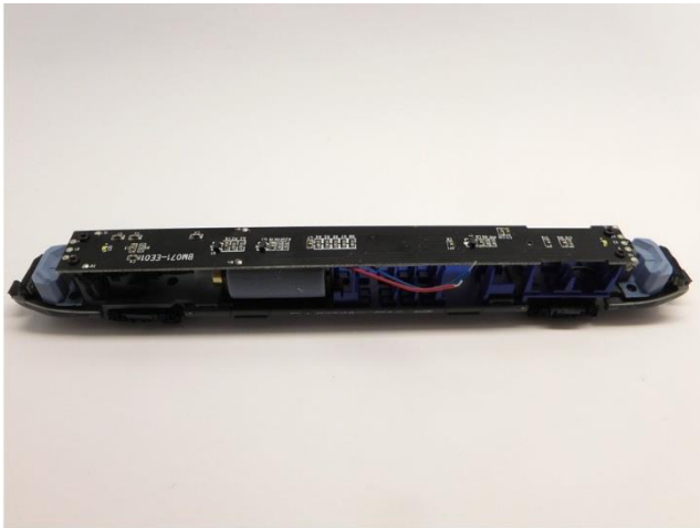
Platine platzieren Mount PCB Plaats de printplaat
